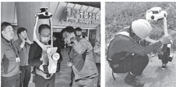
東京公共嘱託登記土地家屋調査士協会が作業機関として平成30年に地図作成作業を行った千駄ヶ谷1・2丁目の一部地域を4つのエリアに分け、令和6年5月に(株)日本インシーク様のご協力のもと観測を行った。各エリアの2・3級基準点はおおむねエリアの角に位置している。地図作成作業で設置した法務局4級基準点は約40～50mの間隔で配置されている。厳密網平均計算での4級基準点及びTS観測による境界標の座標値を正解値として、NavVisVLX3で計算した座標値との差分及び問題点を検討した。
